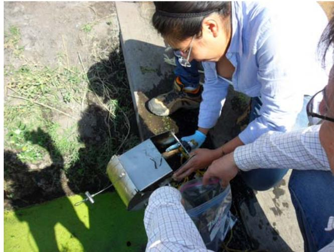
Figura 99. Toma de muestras de sedimento mediante el uso de una draga tipo Eckman.
