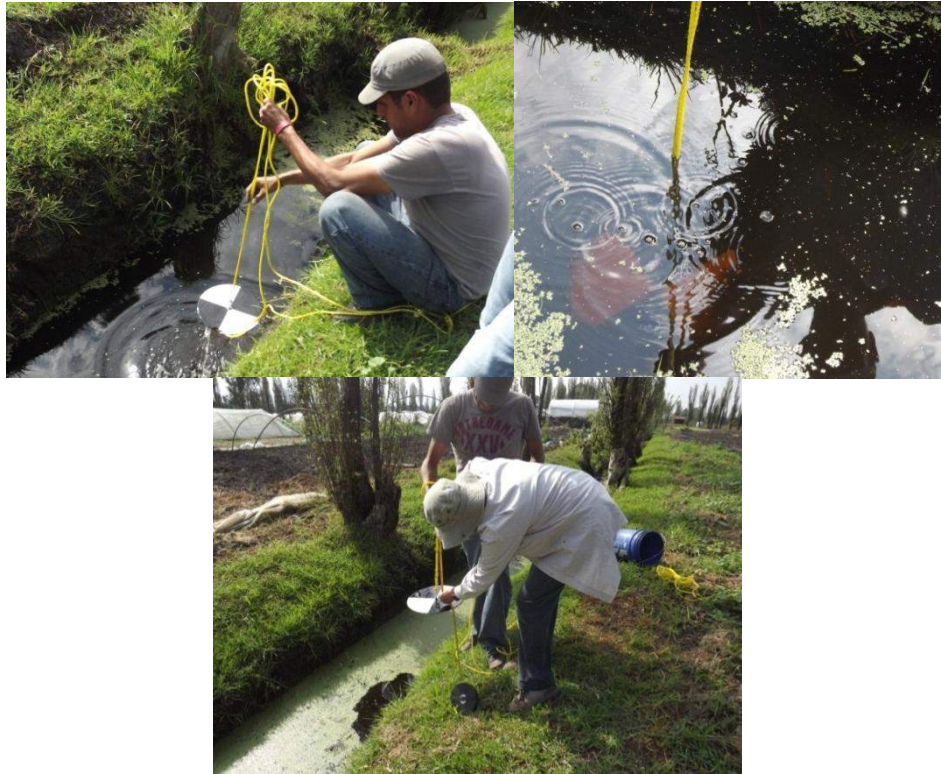
Figura 199. Medición de transparencia en la zanja de 40m.
