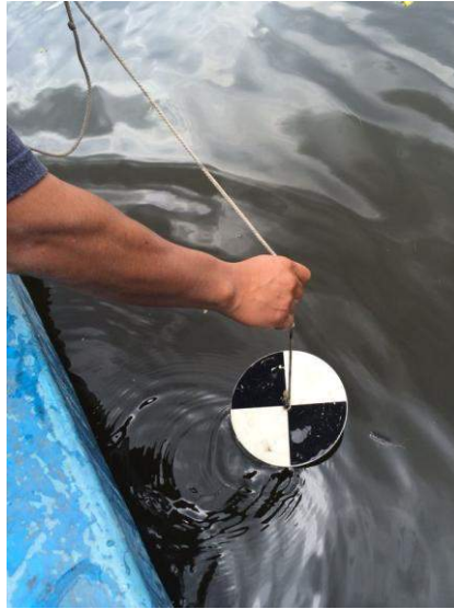
Figura 14. Determinación de la transparencia y profundidad del agua en los sitios de muestreo.
