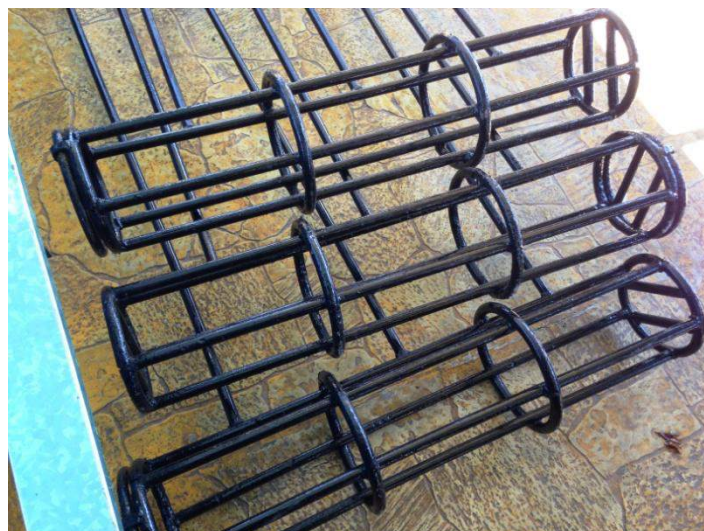
Figura 3. Jaulas metálicas para resguardo de sondas YSI.
